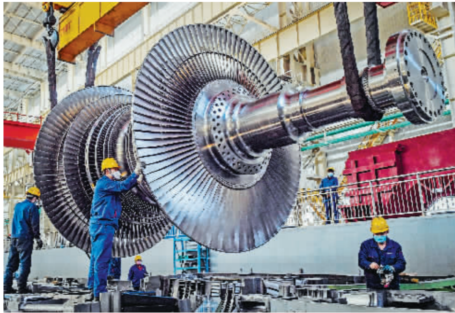
哈电汽轮机为“一带一路”印尼雅加项目制造的汽轮机设备正在紧张加工。 本报记者 韩伟 孙岩 刘洋 赵亮摄
